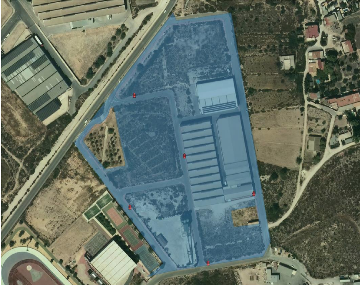
Ilustración 4. Localización de los hidrantes en el polígono industrial Imperial. Fuente: Elaboración propia
